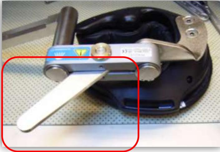
Modifizieren des Klemmgriffes durch Abtrennen und Anschweißen eines neuen Griffes
